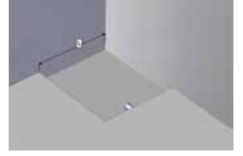
Uygulama yapılacak alanı ölçüsünü Belirleyerek toz ve artıklardan arındırınız. Setting the size and cleaning the shower area from powder and waste.
