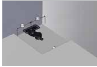
Yan çıkışlı Lineer kanalı zemin merkezine yerleştiriniz. Side outlet place the linear channel center of floor.
