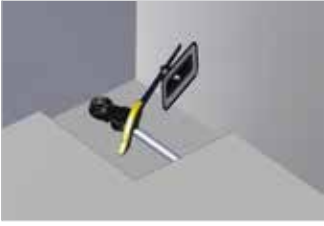
Koruyucu straforu çıkarak seramik gövde arası mesafeyi ölçünüz. Gereken yüksekliğe göre çerçeveyi kenarda bulunan işaretlerden kesiniz. Remove the protective styropor and measure the blank between ceramic tile.
