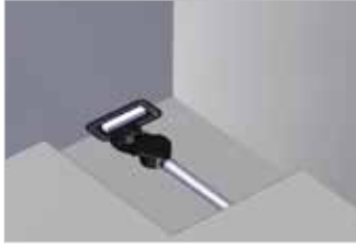
Seramik uygulaması tamamlanana kadar koruyucu straforu çıkarmayınız. Do not remove the protective styropor until the ceramic application is completed.
