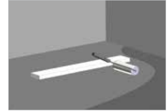
Tüm alana min 2 kat sürme izolasyon ile yalıtım yapınız. Insulate the whole surface min 2 layer with sliding isolation.
