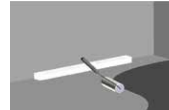
Tüm alana min 2 kat sürme izolasyon ile yalıtım yapınız. Insulate the whole surface min 2 layer with sliding isolation.
