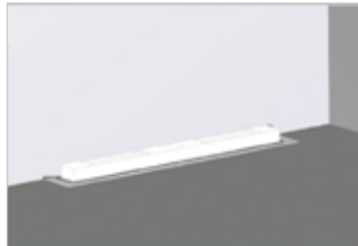
Düzeltilme betonunun meyilini duş kanalına doğru min %1 eğimle veriniz. Bevel the slant of leveling concrete min 1% towards shower channel.
