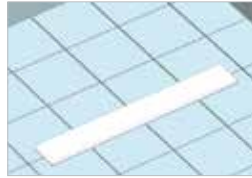
Seramik uygulaması tamamlanana kadar koruyucu straforu çıkarmayınız.
