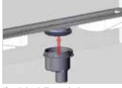
Sifon gövdeye bağlanmış olması
