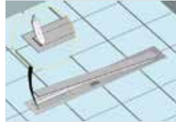
Kapak anahtarının yardımıyla sifonu temizleyiniz.
