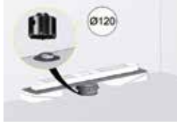
Boru bağlantısı için beton çukurdak matkap yardımıyla delin
