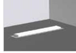
Düzeltme betonunun meylini duş kanalına doğru min %1 eğimle veriniz.
